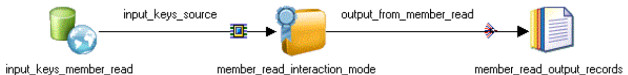
Figure 1. Exemple d'utilisation de l'étape MDM Connector pour lire les données du serveur MDM
