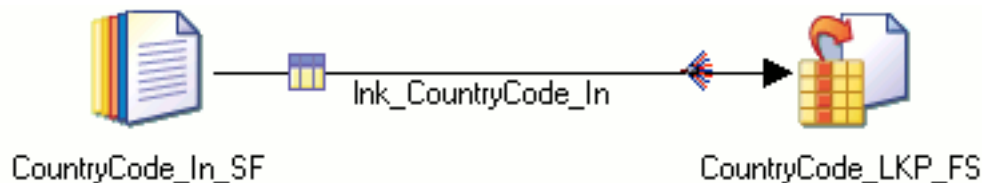
Abbildung 2. Ihr erster Job umfasst eine Stage Sequential File , die in eine Stage Lookup File Set schreibt.
